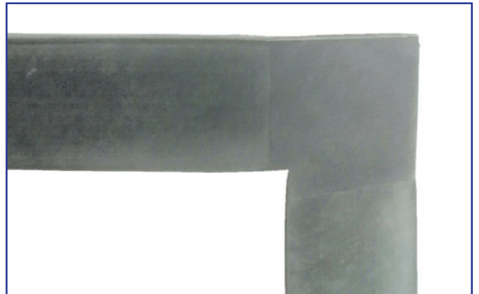
Совулканизация пластин под углом 90 градусов
