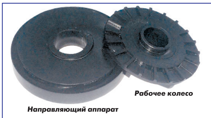
Рис. 8 Рабочая ступень центробежного насоса малой дебитности (25 м³/сут.)
