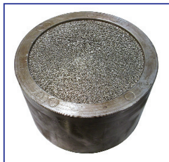
Фильтр сажевый для легковых автомобилей с дизельными двигателями с рабочим объемом до 2,5 л
