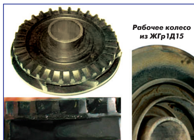
Рис. 6,а Сравнительные испытания абразивной стойкости рабочих колес (РК), выполненных из материала "КАРБУЛ С-С" и порошка ЖГр1Д15
