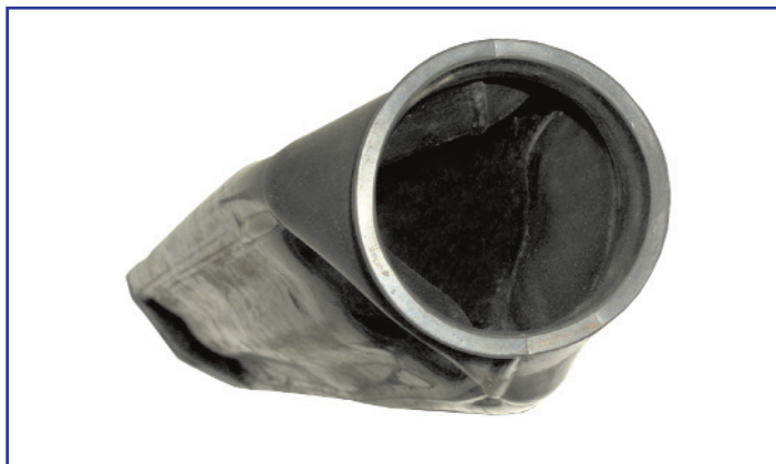
Рис. 4. Диафрагма из поднятой гидрозащиты нового поколения МГ54 производства ОАО "АЛНАС"
