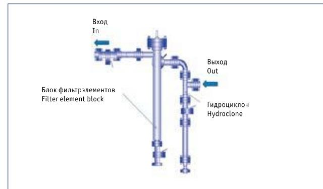
Рис. 4. Общий вид установки системы подготовки воды для подготовки воды системы поддержания пластового давления
