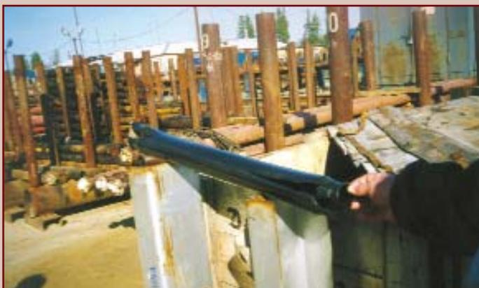
Разрыв диафрагмы погружного электронасоса
